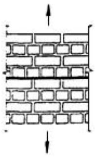
Рисунок 1 - Растворение кладки по неперевязанному сечению
