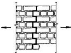
Рисунок 2 - Растворение кладки по перевязанному сечению
