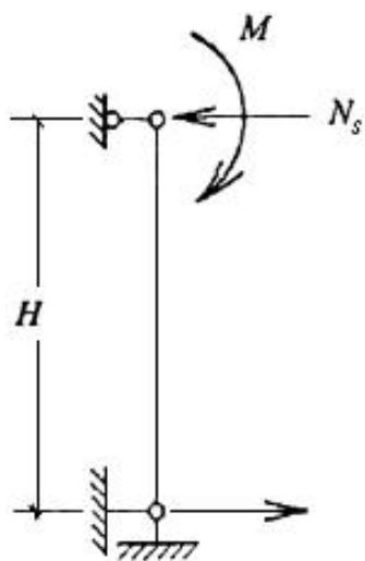
9.39 В случае назначения толщины стены или перегородок с учетом опирания по контуру необходимо предусматривать их крепление к примыкающим боковым конструкциям и к верхнему перекрытию.
