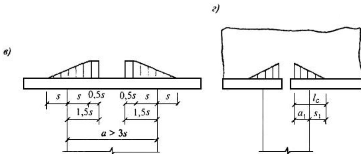
$a$  - на средних опорах неразрезных балок при  $a \leq 2s$ ;  $b$  - то же, при  $3s \geq a > 2s$ ;
