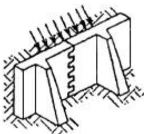
Рисунок 3 - Растворение кладки при изгибе по перевязанному сечению
