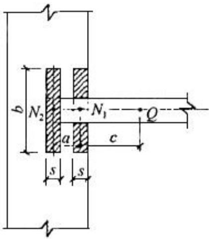
Рисунок 14 - Расчетные схемы заделки консольных балок
